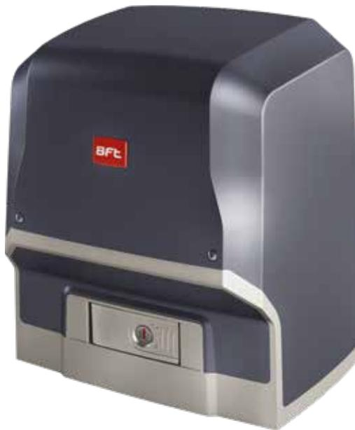
Operatori 24V per cancelli scorrevoli fino a 1500kg, ad uso intensivo. Velocità massima dell'anta fino a 12m/min. Controllo della coppia tramite tecnologia D-track. Finecorsa elettromeccanici. Centrale di comando con trimmer e dip-switch. Uso residenziale e commerciale.
