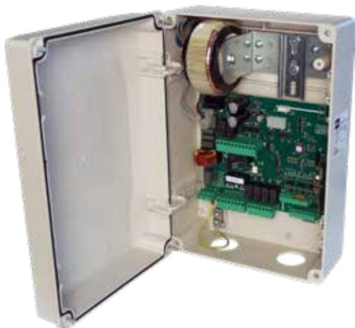
Quadro di comando a display per uno o due operatori 230V utilizzato nei dissuasori di sosta di tipo elettromeccanico o idraulico. Può gestire fino a quattro dissuasori contemporaneamente (o due nel caso dei modelli Xpass 1200) ed ha uscite configurabili ed un connettore per una ricevente radio 433 MHz con memoria a 2048 codici opzionale.
