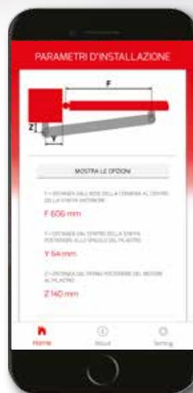
**3. L'App calcola in automatico le misure di installazione**
