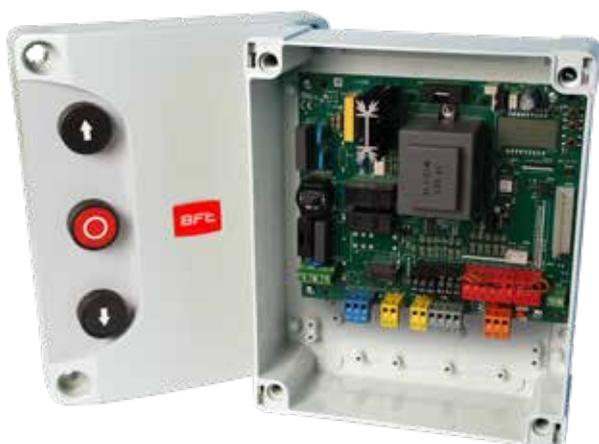
Quadro di comando a display per un operatore 230V/750W utilizzato nei cancelli scorrevoli, porte sezionali industriali e sbarre automatiche, con funzionamento di rilevamento ostacoli ottenibile con costa sensibile oppure con encoder BFT. Gli ingressi di comando sono configurabili, il ricevitore radio è incorporato con tecnologia rolling code e le morsettiere sono colorate ed estraibili per rendere più agevoli le operazioni di cablaggio.
