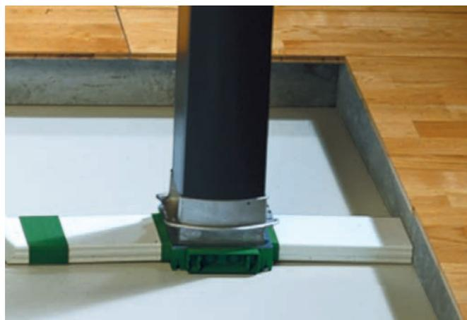
La base delle colonne BIS è studiata per garantire l'integrazione con il canale sotto pavimento affogato METRO' FAST. Utilizzando la scatola MCD-T-C del METRO' FAST si garantisce una totale rigidità meccanica dell'installazione grazie alla base metallica.
