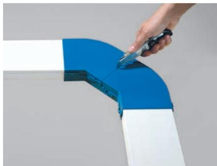
La curva piana TCP-N si può installare immediatamente per angoli a 90°. È facilmente riconducibile ad angoli di 45° con un semplice taglio lungo l'apposita linea di riferimento.
