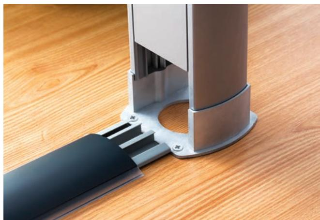
La colonna UNA è perfettamente integrabile con il canale sopra-pavimento CSP-N. L'operazione da eseguire è estremamente semplice: è sufficiente mandare in battuta il canale alla base tecnica nella sede dedicata e tagliare il raccordo di finitura seguendo le opportune linee di riferimento.
