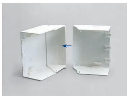
Nel caso di angoli di ampiezza superiore a 90° è necessario tagliare la differenza di spessore indicata sulla superficie interna dell'elemento NEAV-2.
