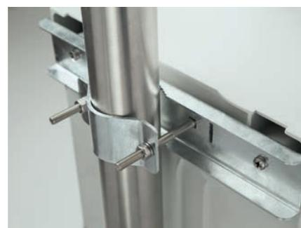
Gli attacchi a palo consentono l'applicazione dei quadri PEDRO su pali con diametro da 48 a 80mm; per pali da 80 fino a 200mm utilizzare reggia metallica 19x0,76mm (non fornita in dotazione)
