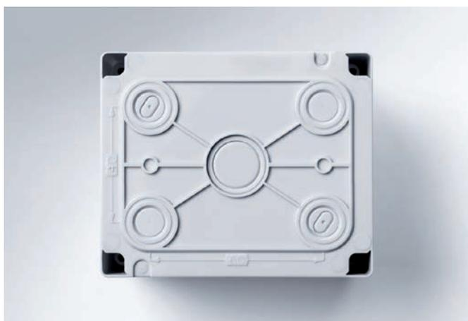
I fondi dei contenitori IP40 e IP55 sono caratterizzati da punti di fissaggio a muro con asole per facilitare la messa in bolla, e da prefrittura centrale per l'ingresso con tubi corrugati diametri 16 e 20 mm.
