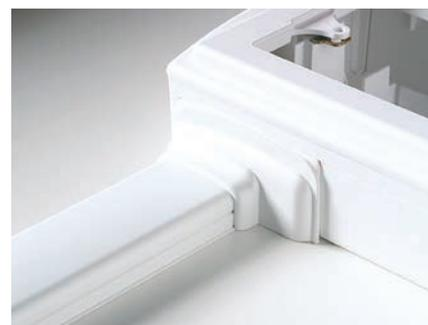
Il raccordo, in dotazione nelle scatole porta apparecchi e di derivazione, consente l'ottimale integrazione con i canali permettendo di ottenere il grado IP40. Le apposite linee di prefattura interne al raccordo facilitano le operazioni di taglio. Su scatole porta apparecchi e di derivazione sono sufficienti due tagli verticali per posizionare il raccordo e realizzare l'accoppiamento componente/canale.
