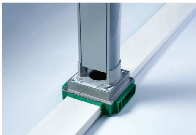
La base della colonna UNA è studiata per garantire l'integrazione con il canale sottopavimento affogato METRO' FAST. Utilizzando la scatola MCD-T-C del METRO' FAST si garantisce una totale rigidità meccanica dell'installazione grazie alla base metallica. In tali applicazioni si consiglia l'installazione della PIASTRA UNA tra la scatola MCD-T-C e la colonna UNA.
