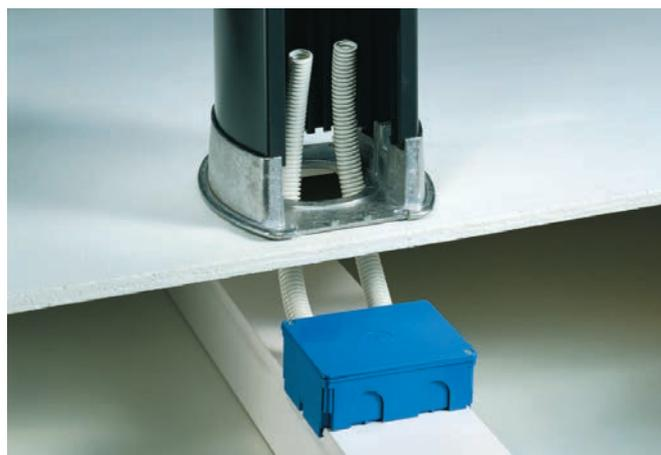
Le colonne BIS sono integrabili anche con il canale TUNNEL FAST idoneo per impianti in pavimenti flottanti. Attraverso il foro presente sulla base è possibile estrarre i tubi corrugati per portare l'alimentazione alle utenze installate sulla colonna.
