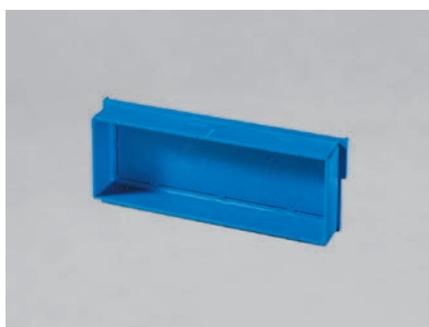
La paratia della scatola di derivazioni TSM è predisposta per raccordare sia il canale TUNNEL FAST 120x40 che 3 tubi di differente diametro (16-25-32 mm). Il montaggio della paratia è a scorrimento sul telaio della scatola.
