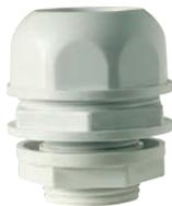
**Raccordo, sistema chiuso con guaina spiralata (GSIG - GSI), autoestinguente - con dado di fissaggio passo 1,5 ISO 262. Il diametro nominale è anche il diametro interno minimo del sistema.**
