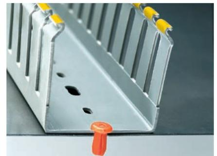
Sfruttando l'impugnatura ergonomica dell'utensile si inserisce facilmente il rivetto nel foro. Premendo l'estremità dell'applicatore si completa il fissaggio tramite l'inserimento del perno del rivetto. La divaricazione delle alette dell'elemento di fissaggio ne impedirà l'estrazione.
