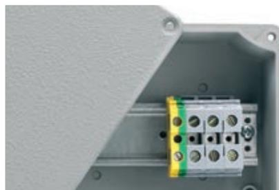
Le cassette, con grado di protezione IP66, possono essere usate come derivazione, con la possibilità di montare piastre di fondo o guide DIN. Il coperchio è dotato di viti di fissaggio imperdibili ed in acciaio inox, mentre il fondo è dotato di inserto per la messa a terra.
