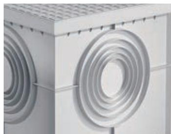
I lati del pozzetto presentano pretrancature di differenti diametri per l'ingresso di cavidotti. Il fondo sfondabile permette che i pozzetti PZ possano essere sovrapposti, realizzando un sistema modulare per aumentare la profondità e la capienza del pozzetto.
