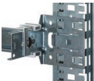
Le staffe delle guide sono state progettate per essere montate senza viti grazie all'innesto sui profili funzionali. Inoltre l'innovativo supporto consente il fissaggio delle guide alle staffe e la loro regolazione in profondità senza l'utilizzo di viti ed attrezzi.
