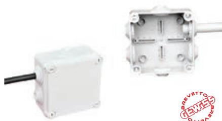
Le cassette dotate di passacavi permettono l'ingresso rapido di cavi rigidi e flessibili. L'innovativa geometria garantisce prestazioni meccaniche elevate e assicura il mantenimento del grado IP della cassetta anche con cavi o tubi inseriti, grazie allo speciale "effetto ventosa".
