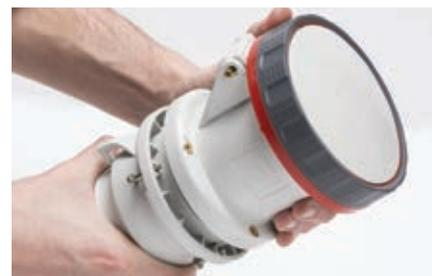
Le versioni 16-32A si contraddistinguono per la chiusura corpo-impugnatura brevettata con rotazione 1/4 di giro SAFE-LOCK, mentre le versioni 63-125A dispongono di un sistema di chiusura con viti imperdibili avvitate su inserti in ottone realizzati con flangia di contrasto maggiorata.
