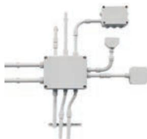
La gamma GEWISS si compone di tubi rigidi RK15 (classificazione 3321), RKB (classificazione 4321) e RKHF (classificazione 4422), disponibili in 7 misure da Ø16 a Ø63 mm, e di specifici complementi di percorso che permettono di realizzare impianti a parete stagni o protetti.
