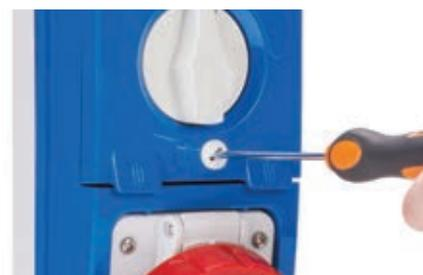
L'innovativo sistema portafusibili estrae automaticamente e simultaneamente i fusibili dalla base mediante apertura portella con vite antimanomissione a ¼ di giro. La portella è infine richiudibile semplicemente premendo con un dito. Disponibile con correnti 16-32-63A.
