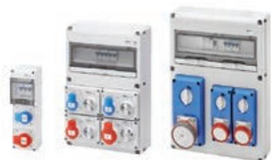
La gamma di quadri per la distribuzione di energia si articola in 23 involucri vuoti con grado di protezione IP65, predisposti per prese da incasso ed interbloccate fino a 63A, ed accessoriabili con numerosi complementi tecnici che ne aumentano i campi di applicazione.
