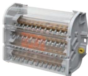
Morsettiere ripartitrici modulari tetrapolari provviste di calotta di protezione trasparente fissaggio su piastra o su guida DIN EN 50022 - 750 V - T 85 °C
