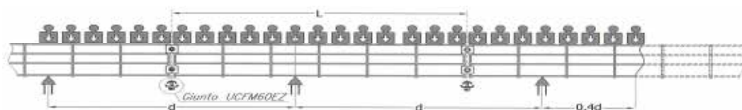
Diagramma di carico / Loading diagram Prova di tipo I [CEI EN 61537:2007-11]/ Test type I
