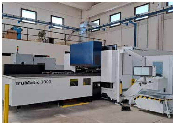
Reparto produzione pezzi speciali con punzonatrici laser Special manufacturing area with laser punching machine
