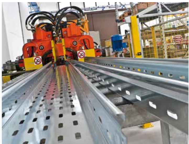
Reparto produzioni canali Cable tray manufacturing area
