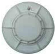
Rivelatore di calore convenzionale. Costituito da un termistore. Intervento a 78°C. LED di visualizzazione allarmi. Uscita per ripetizione d'allarme. Predisposto al test tramite telecomando a laser. Certificato CPR in accordo alla Normativa EN 54-5.
