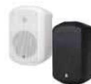
Diffusore monitor a parete, sistema 2 vie con woofer 130 mm e tweeter da 1". Risposta in frequenza 50÷23.500 Hz. Angolo di dispersione orizzontale e verticale @ 2 KHz h:101° V=133°. Struttura in ABS. Completo di morsetto ceramico con termofusibile. Certificato CPR in accordo alla normativa EN 54-24.
