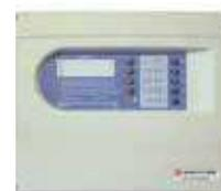
Centrale convenzionale a 2, 4 o 8 zone non espandibile con 2 uscite controllate. Ciascuna linea permette il collegamento di massimo 25 rivelatori o pulsanti convenzionali. Progettata per sistemi di rivelazione incendio di piccole dimensioni. Certificata CPR in accordo alle Normative EN 54-2 e EN 54-4.
