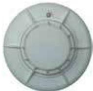
Rivelatore di calore termovelocimetrico convenzionale. Costituito da un doppio termistore. Intervento a 58°C. LED di visualizzazione allarmi. Uscita per ripetizione d'allarme. Predisposto al test tramite telecomando a laser. Certificato CPR in accordo alla Normativa EN 54-5.
