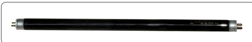
T5 e T8 a luce di wood (BLB), dotate di un particolare vetro blu scuro che, mentre assorbe le radiazioni visibili, emette solo ed esclusivamente le radiazioni ultraviolette UV-A a 365 nm; utilizzi tipici sono controlli di produzione, apparecchi per effetti speciali per discoteche e bar, verificatori di banconote e carte di credito, fissaggio e sviluppo di vernici fluorescenti all'interno di camere oscure, apparecchi per analisi geologiche
