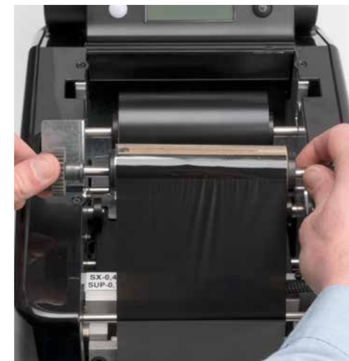
Avvolgimento e bloccaggio del nastro sul supporto anteriore
