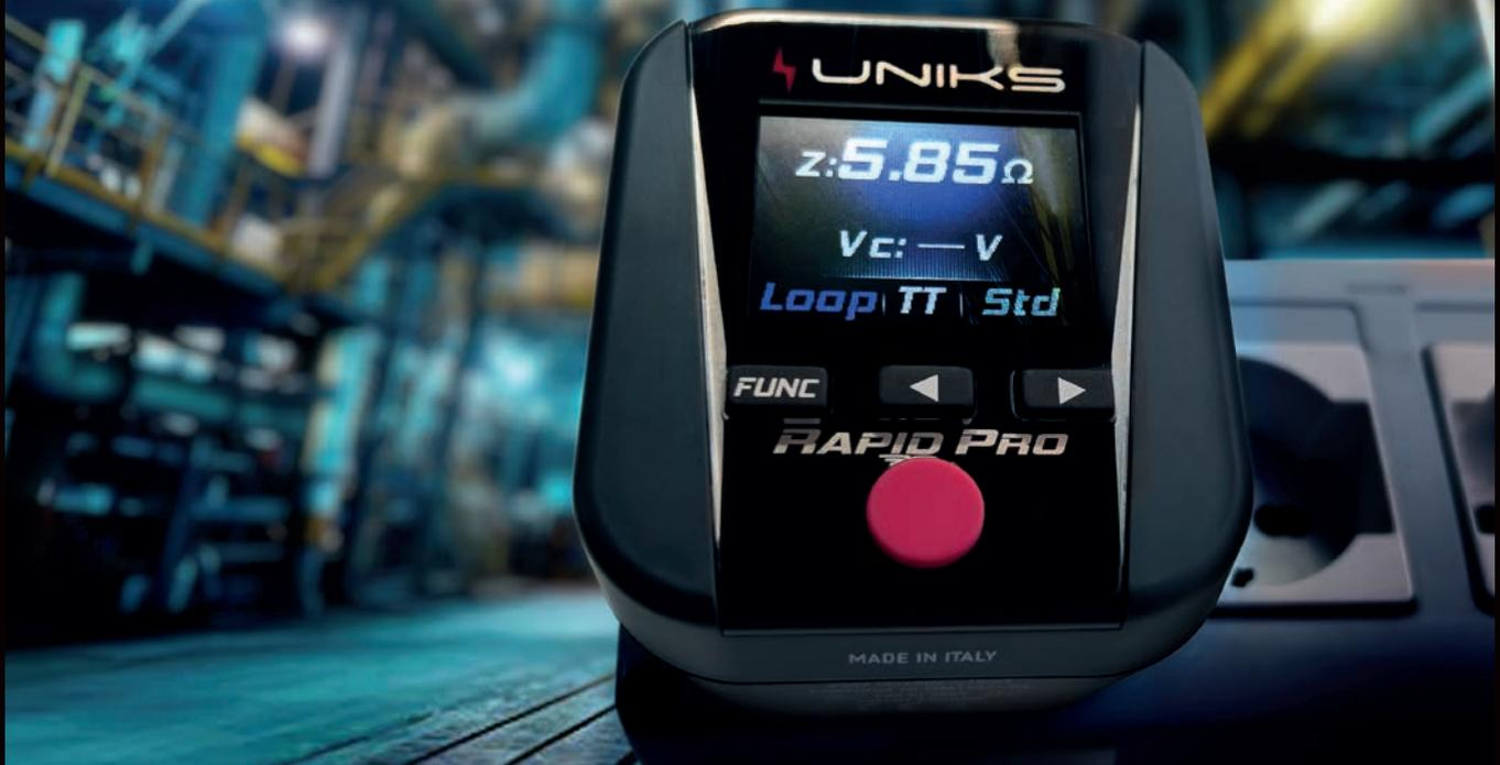
Digitaloop™, l'innovativo metodo brevettato da UNIKS, sta trasformando il modo in cui misuriamo l'impedenza del loop negli impianti elettrici. Grazie al suo algoritmo digitale avanzato, abbiamo dato vita a prodotti più compatti e innovativi, eliminando la necessità di componenti di potenza.
