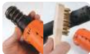
Svitare la canna e spazzolare l'esterno e l'interno
