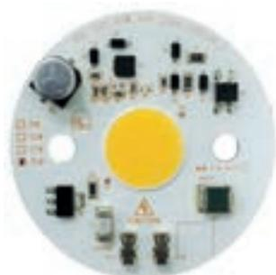
LED alimentati direttamente a 230VAC ad elevate performance ed elevata luminosità.
